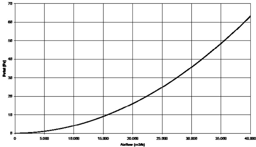
Druck und Luftmengen dürfen die maximalen Werte (60 Pa und 38.000 m³/h) nicht überschreiten.
