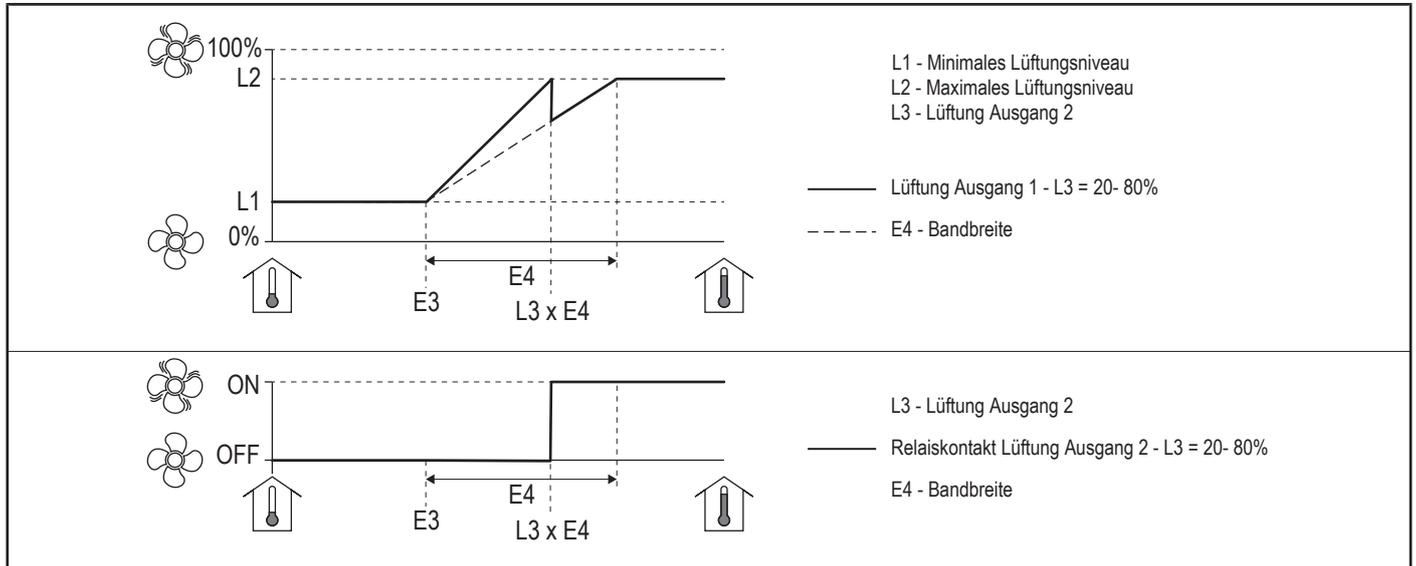
Abb. 5: Lüftung Ausgang 2 - [20 – 80%]
