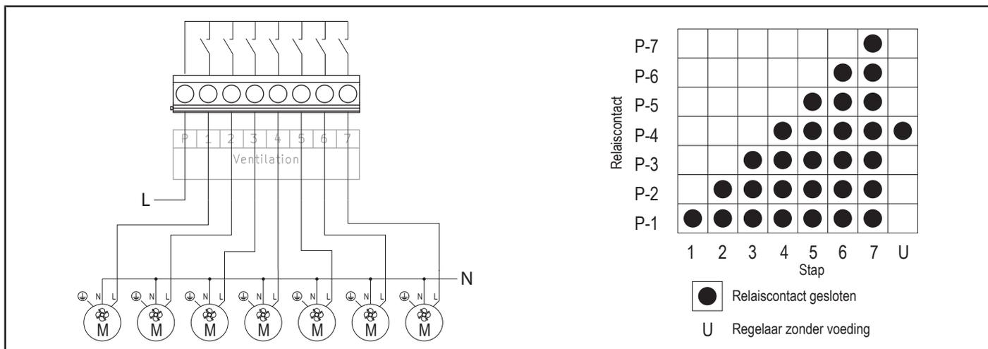
Afbeelding 3: ETD-CN Stap contacten aansluitschema
