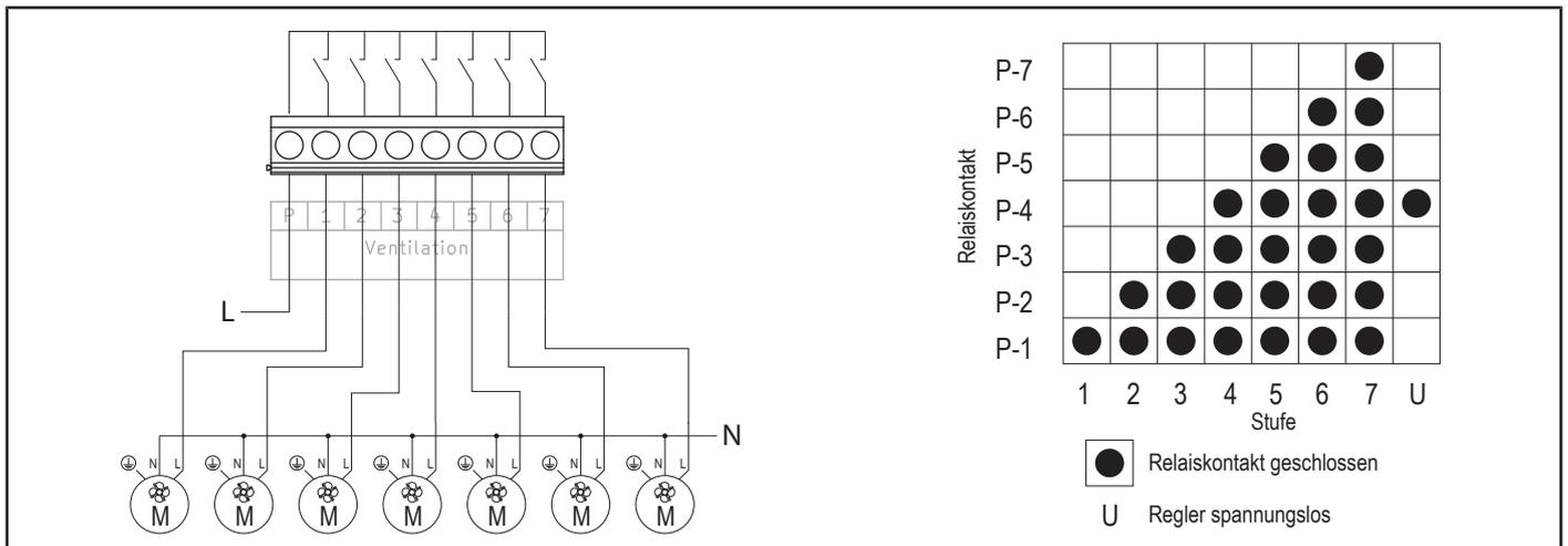
Abb. 3: ETD-CN Stufenkontakte Schaltplan
