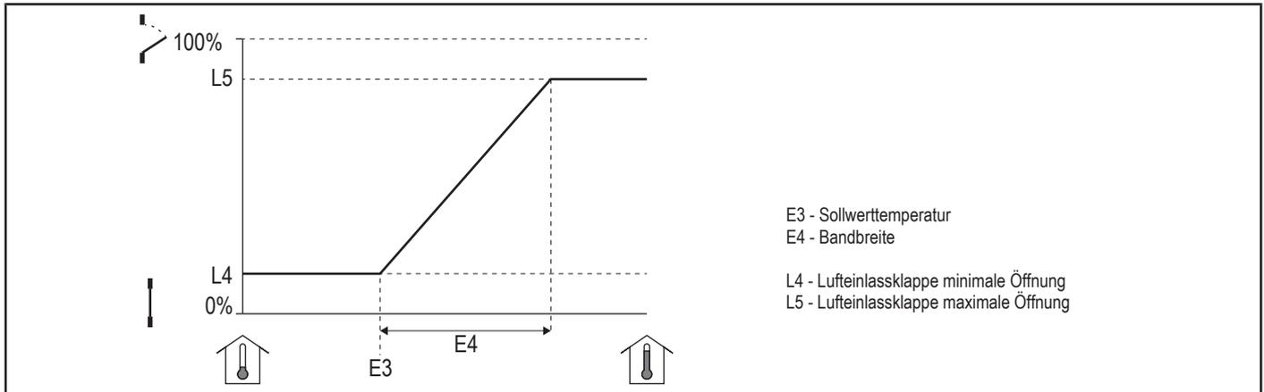
Abb. 7: Lufteinlassklappenöffnung [0 - 10 V]
